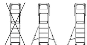
Toujours déployer les stabilisateurs. Lorsque la PIRL est placée contre un mur, un seul stabilisateur est nécessaire.
