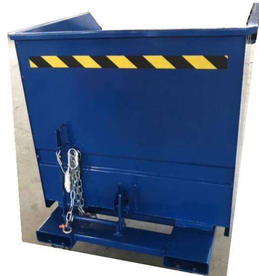
Le câble en nylon est à attacher au levier qui va permettre l'ouverture de la benne depuis le chariot (le conducteur n'a pas besoin de descendre du chariot pour ouvrir la benne)
