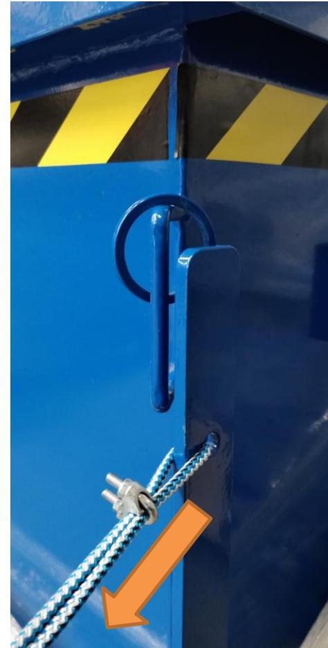
*Tirer sur le câble depuis le chariot élévateur pour ouvrir la benne*
