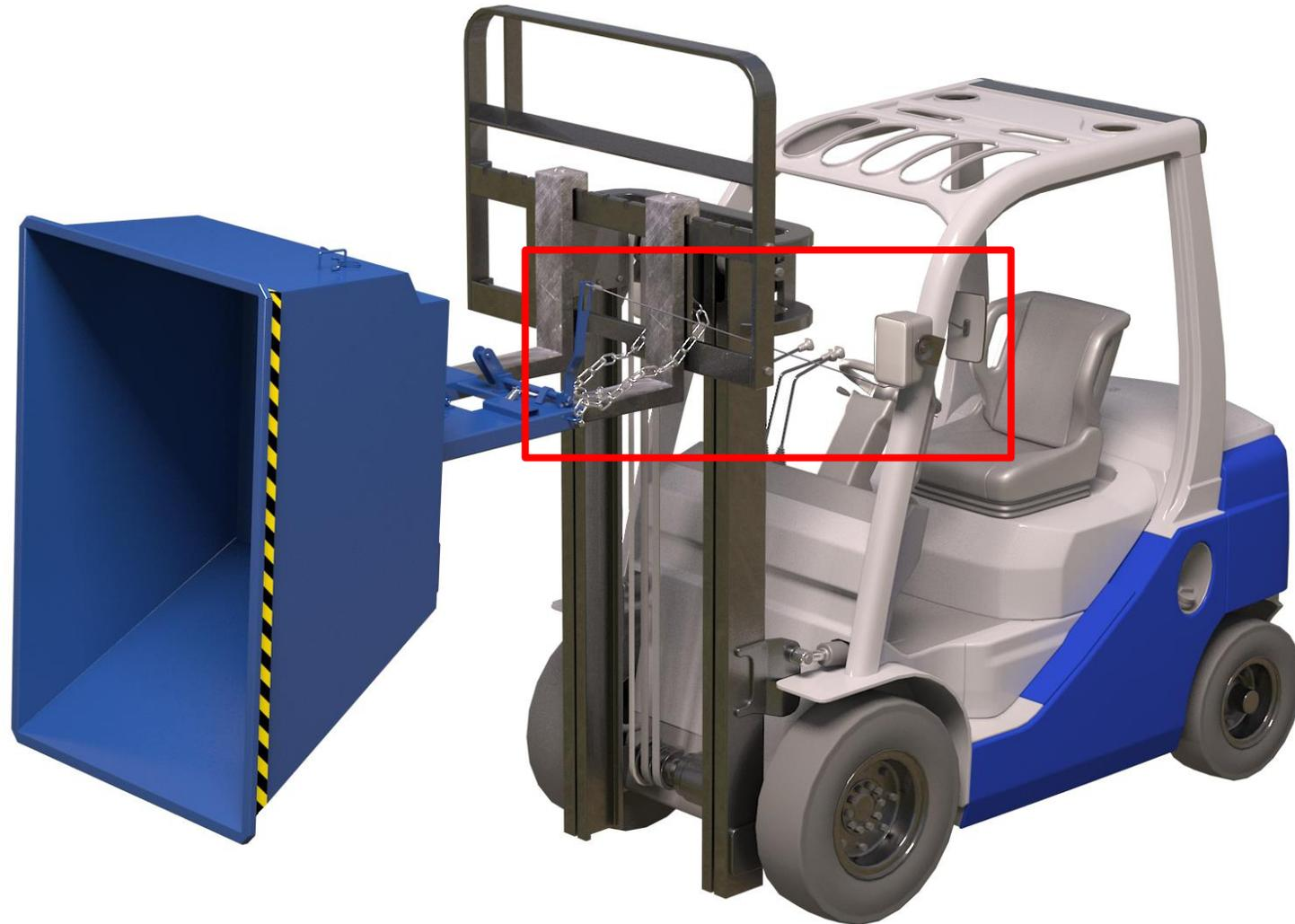
L'anneau de sécurité est à positionner sur le levier **dès que la benne est en déplacement.**
